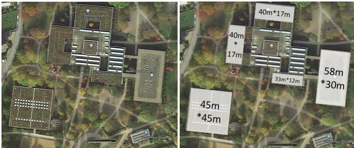
Abbildung 30: Links: Aufsicht auf Schulzentrum zeigt freie Flächen für die Installation einer großen PV-Anlage. Die auf dem Foto sichtbare bestehende PV-Anlage wurde inzwischen abgebaut. Rechts: Abmessungen des Schuldaches
