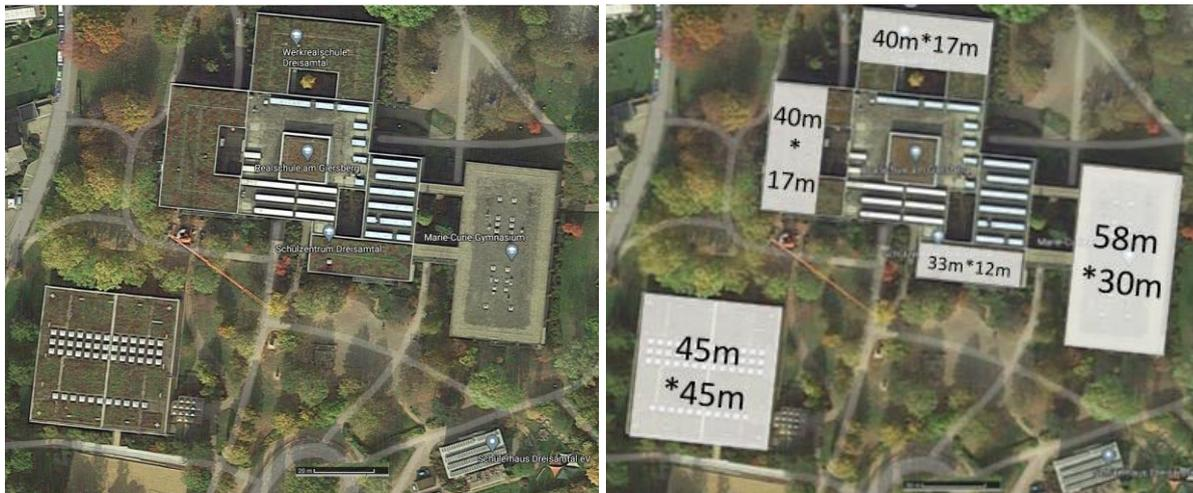
Abbildung 30: Links: Aufsicht auf Schulzentrum zeigt freie Flächen für die Installation einer großen PV-Anlage. Die auf dem Foto sichtbare bestehende PV-Anlage wurde inzwischen abgebaut. Rechts: Abmessungen des Schuldaches.
